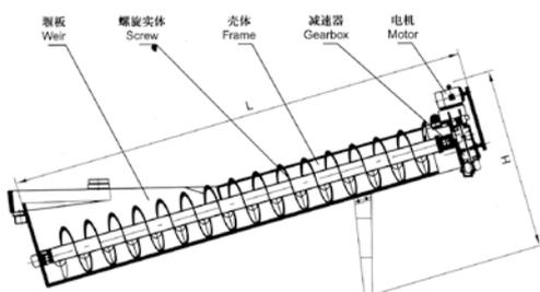
Щебнеочистители серии XL могут промывать и отделять глину и посторонние примеси в щебне. Их оригинальная герметичная конструкция, регулируемая сливная панель и надежная передаточная конструкция гарантируют эффект промывания и осушения, могут использоваться для автодорог, гидроэнергетике, строительстве и других областях.
